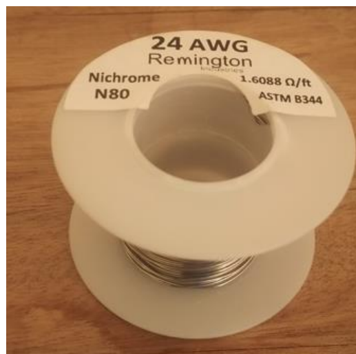
Figure 50: Fil résistif Nickel-Chrome 80/20
