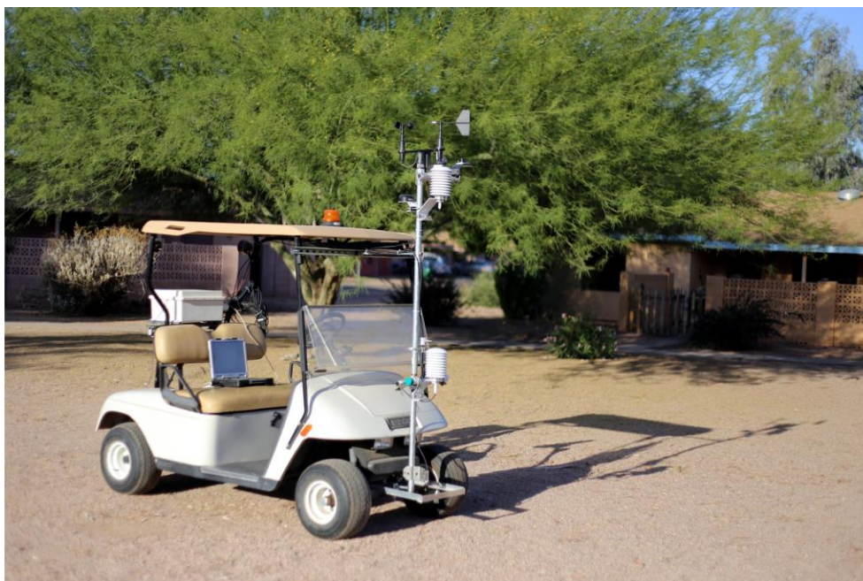
Figure 44: Mesure de conditions climatiques avec un dispositif mobile (Sen et al., 2019)
