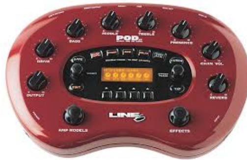
Figure 135. Multi effets / simulateur d'amplificateur POD XT produit par la société Line6. Trente centimètres de large. Poids : 1 kilo.
