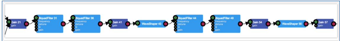
Figure 150. Préamplificateur avec topologie en série. Ici un exemple de préamplificateur à deux étages, chacun composé d'un nœud WaveShaper (bleu clair, fin), de deux filtres (bleus clairs, épais) et d'un gain (bleu foncé).
