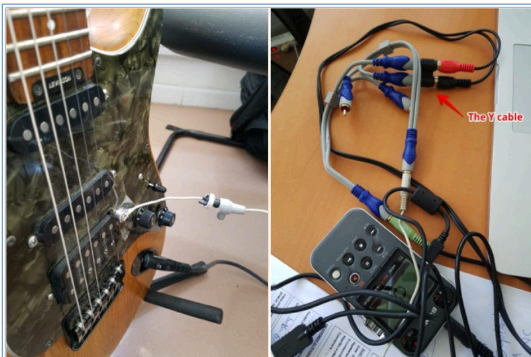
Figure 163. Configuration matérielle de la mesure de latence.
