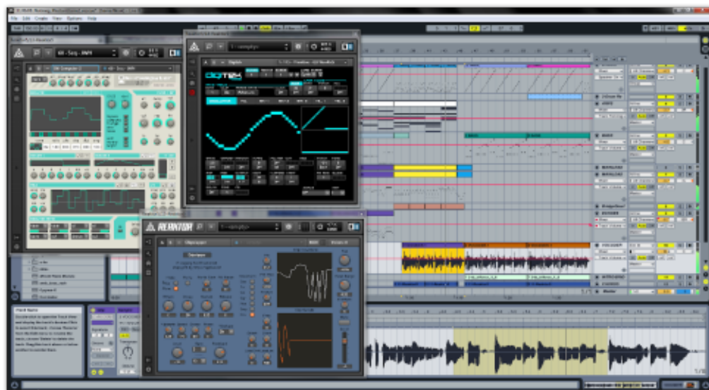
Figure 139. La station de travail audio-numérique Ableton live avec des plugins (sur la gauche). A droite : les pistes d'enregistrement sur lesquelles on va appliquer les traitements audio proposés par ces plugins.
