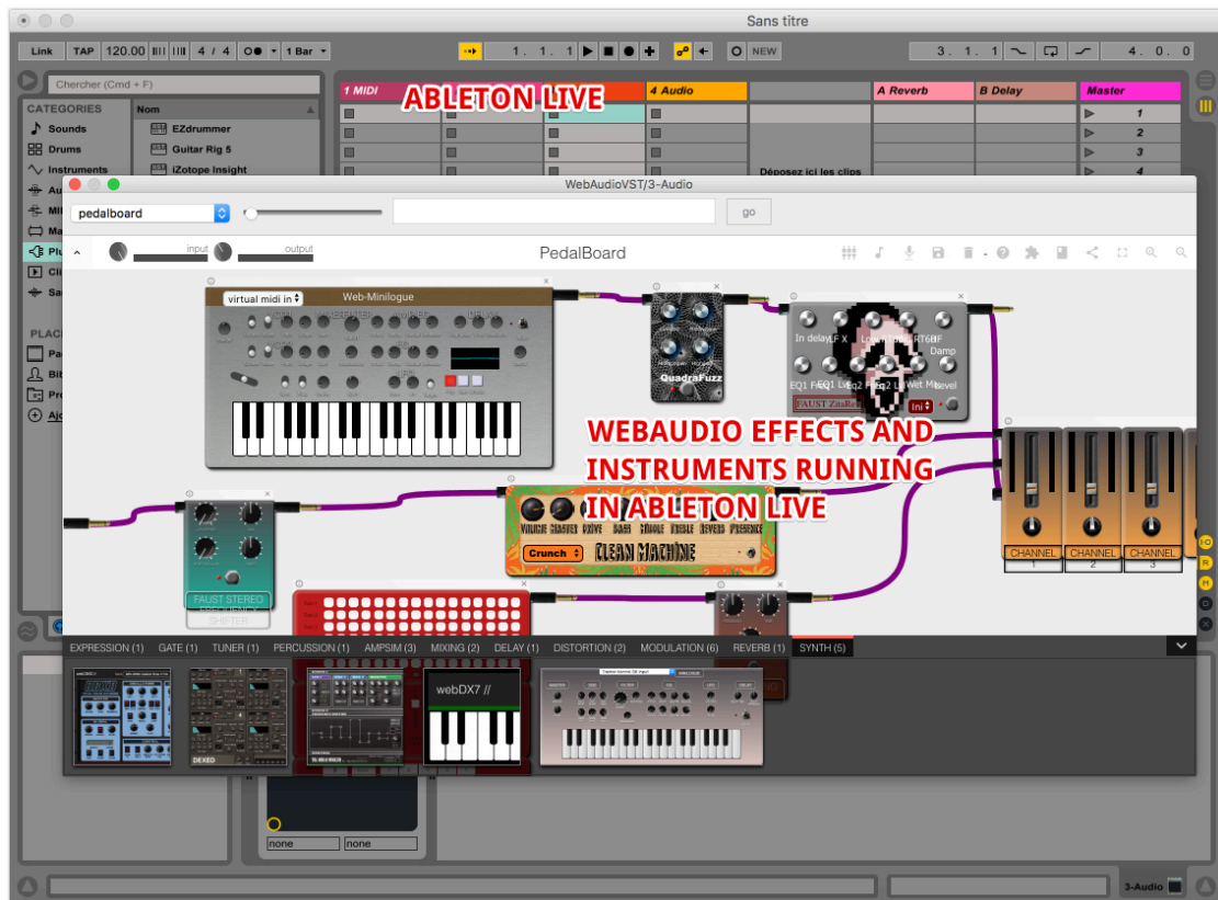
Figure 190. L'application pedalboard dans un plugin VST2 embarquant une version spécialement modifiée de CEF (Chromium Embedded Framework) pour rediriger les I/O sons et midi. Ce plugin intitulé WebAudioVST est chargé dans la station de travail audio numérique Ableton Live. On peut ainsi utiliser sans latence supplémentaire notable les plugins Web dans des environnements natifs.
