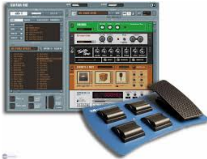
Figure 138. Guitar Rig 1 par Native Instruments. Le pédalier MIDI associé se branche sur un port USB de l'ordinateur et permet de commander le logiciel.
