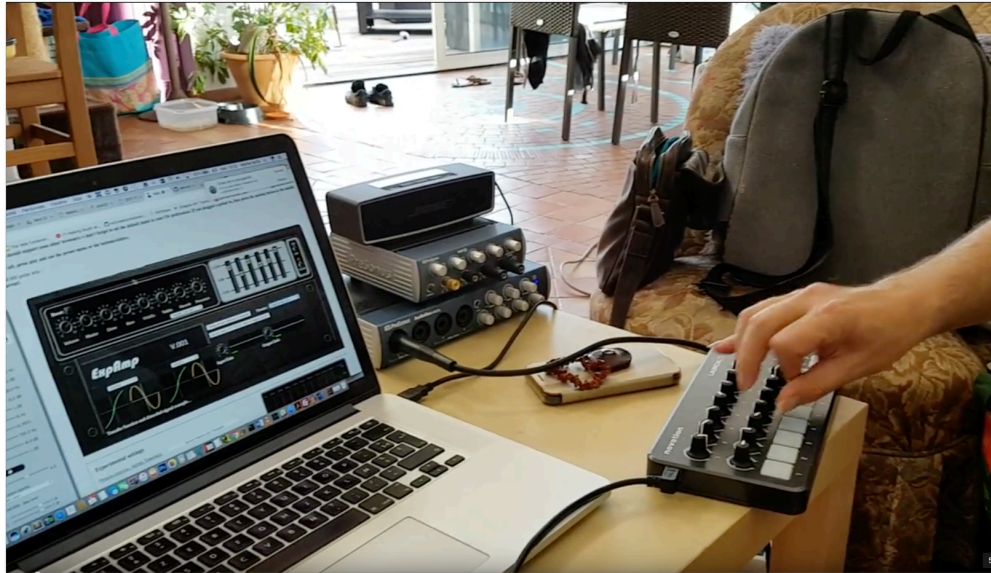
Figure 166. Un contrôleur MIDI permet facilement de modifier les réglages des instruments et effets WebAudio virtuels, sans quitter son instrument.
