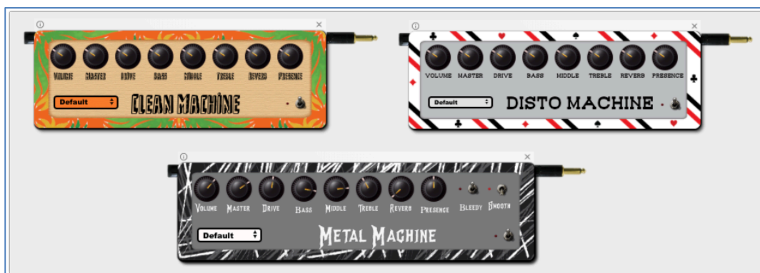
Figure 133. Trois amplificateurs ayant une conception différentes, générés par l'outil de la figure précédente. Le premier produit des sons approchant le son d'une guitare acoustique, le second des sons « classic rock » et le troisième des sons « métal ».
