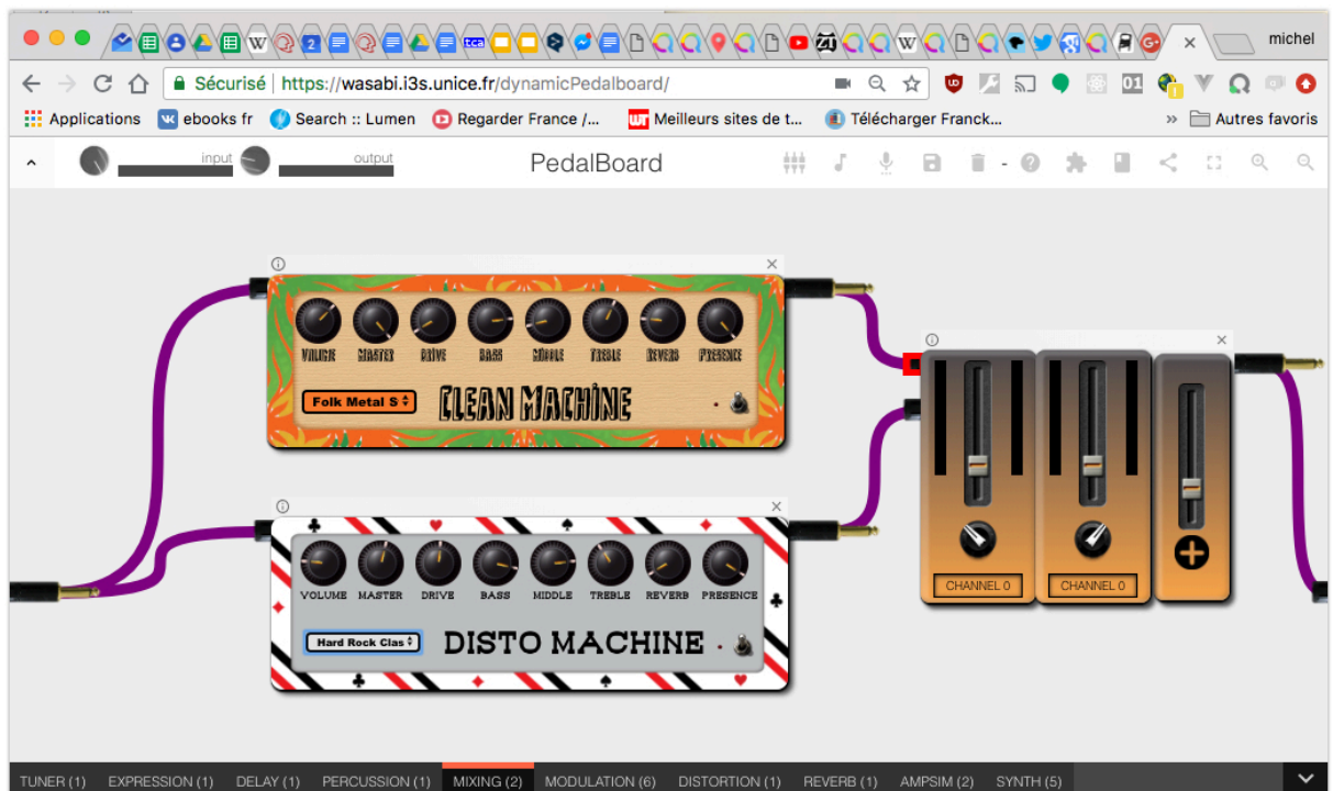
Figure 170. Ici deux amplificateurs créés à partir de fichiers de configuration. Le « Clean machine » possède un préamplificateur multi-bandes et produit des sons très clairs. Le « Disto Machine » est une réplique du JCM800.
