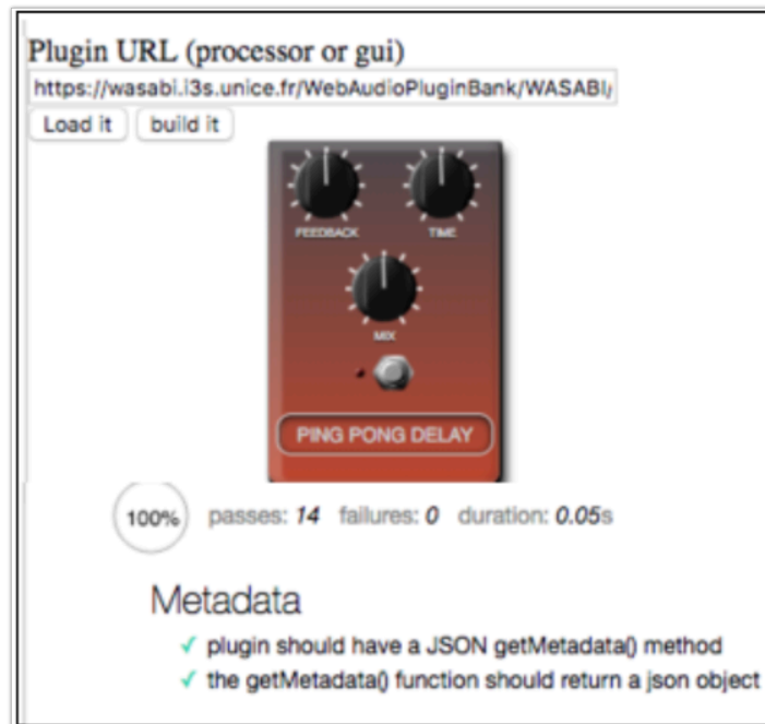
Figure 178. Testeur de plug-in en ligne : on entre l'URI du plug-in pour tester et valider le plug-in avant de le publier dans un dépôt.
