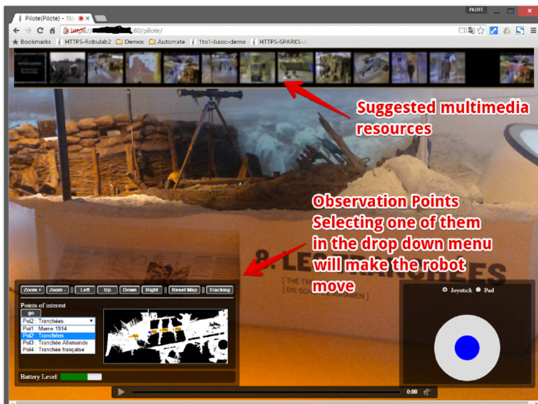
Figure 108. Cette deuxième vue commutable présente les ressources multimédias suggérées. En cliquant sur l'une d'elles, l'url de la ressource sera envoyée au client pour un rendu local (vidéo, image, html).
